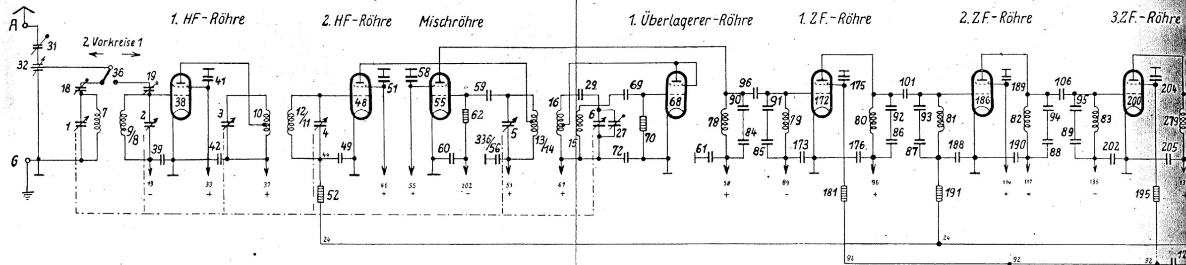
Anmerkung: Darstellung gilt für Frequenzbereich I, Bandbreitenschalter in Stellung 1, Betriebsart „Tn“ (Telefonie od. Telegrafie tönend), mit Selbstregelung.
